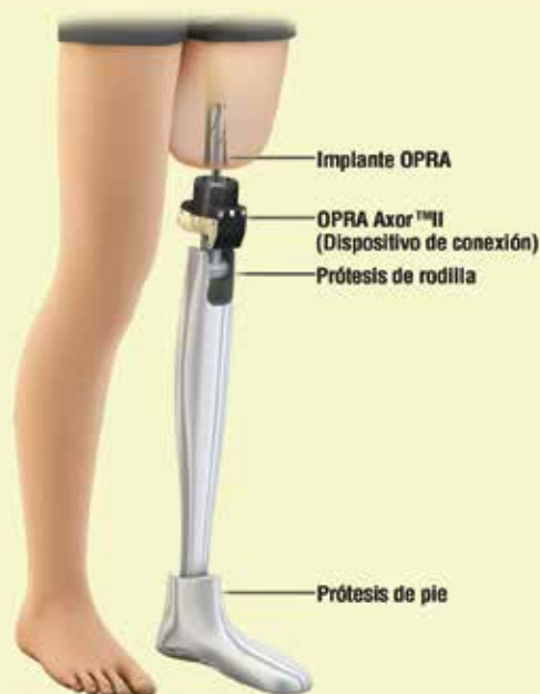
Figura 7. El sistema de implante OPRA es un ejemplo de una prótesis de pierna osteointegrada que está unida directamente al hueso mediante la inserción de un implante de titanio roscado en la médula ósea en el extremo amputado de la extremidad residual.
