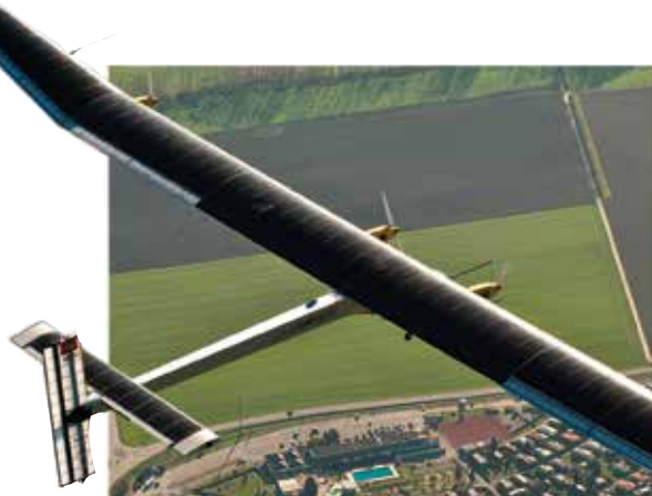
El Solar Impulse, un avión solar dotado con 12,000 celdas solares, completó un vuelo de 26 horas en julio de 2010, un tiempo récord de vuelo para un avión impulsado por energía solar.
