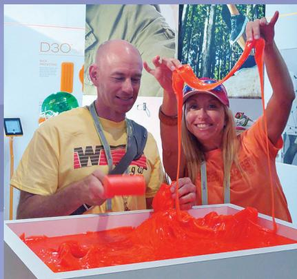
**D3O® en su estado crudo fluye y se estira fácilmente. Pero cuando se mueve rápidamente, se bloquea firmemente, absorbiendo instantáneamente la energía.**
