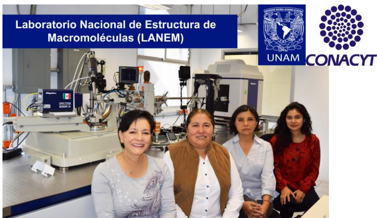
Equipo de difracción de rayos X de ánodo rotatorio MicroMax-007 con detectores DECTRIS-PILATUS y RAXIS-VI++
