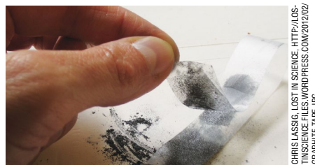
La cinta adhesiva puede ser usada para pelar el grafito pulverizado, dejando una sola capa de grafeno.
